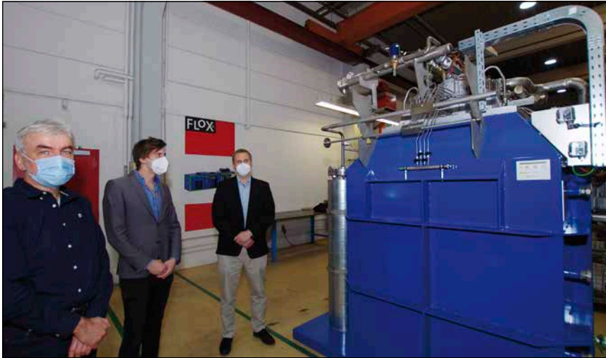
Bild 1: Der erste fertige Biogas-Reformer im WS-Werk, bevor er in den Container eingebaut wurde. Auf dem Bild von links: Die Geschäftsführer Dr. Roland Berger (eflox GmbH), Dr. Andy Gradel (BtX GmbH) und Dr. Martin Schönfelder (WS-Wärmeprozess-technik GmbH)
